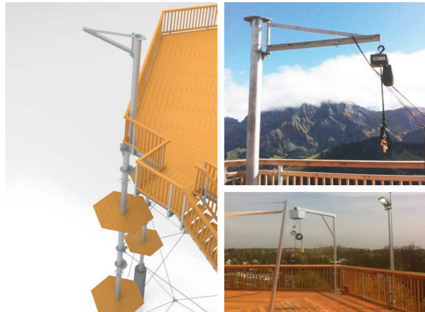
La grúa de carga permite elevar y bajar cómoda y rápidamente grandes cantidades de material e instrumental pesado a la plataforma. Esto facilita especialmente la preparación y la realización de actividades en altura.
