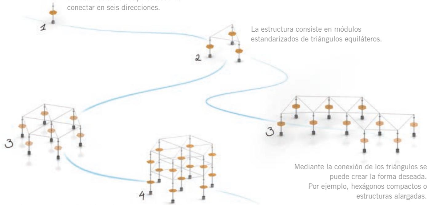
La estructura consiste en módulos estandarizados de triángulos equiláteros.
